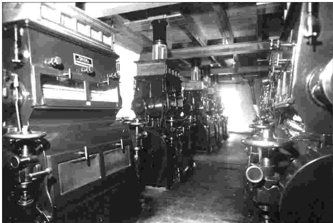
Mlewniki - urządzenia jednego z kłodzkich młynów
